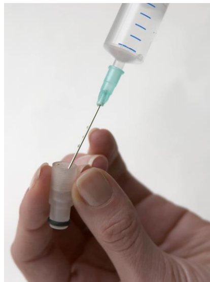
Рисунок 2 – Замена мембраны кислородного датчика
