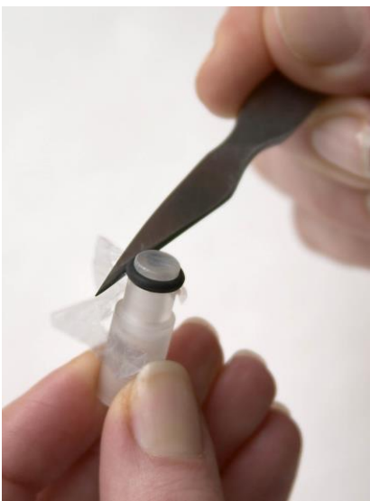
Рисунок 2 – Замена мембраны кислородного датчика
