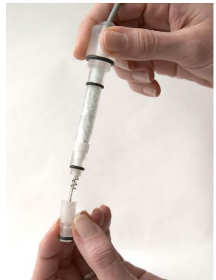
Рисунок 2 – Замена мембраны кислородного датчика
